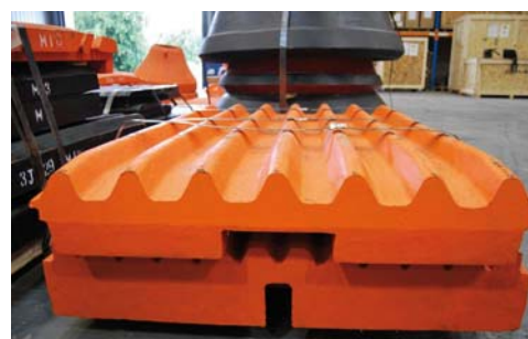
Elementy zużywalne do kruszarek stożkowych (z lewej) i szczękowych
