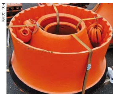
Elementy zużywalne do kruszarek stożkowych (z lewej) i szczękowych
