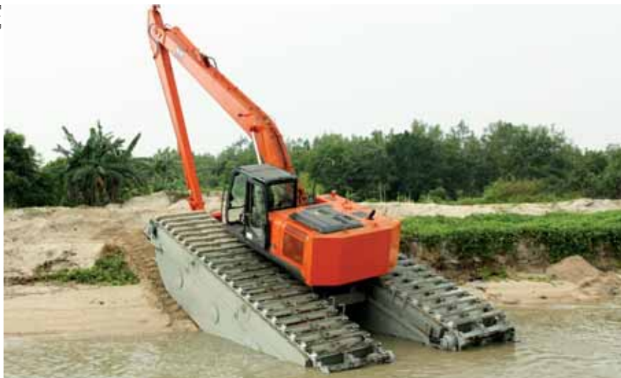
Podwozie pontonowe EIK AM 200 przystosowane do koparek o masie 20–22 t. Widoczny układ jezdny oparty na łańcuchach napędowych heavy duty
