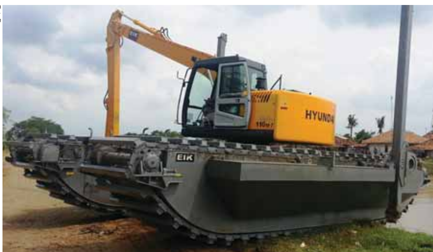
Koparka Hyundai 110M-7 na podwoziu pontonowym AmphiMaster AM 140 (dla maszyn o masie 12-14 t) i dodatkowym systemem stabilizacji/kotwiczenia
